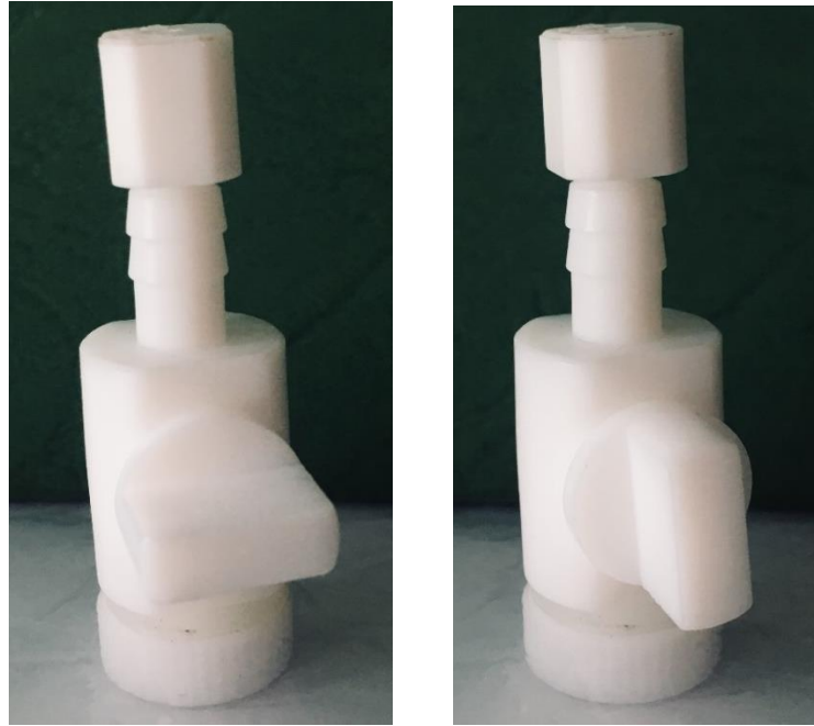
图 9. 注射溶质时气袋直通阀状态(左-关闭, 右-开通)
