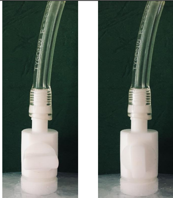
图 7.通气时气袋直通阀状态(左-关闭, 右-开通)
