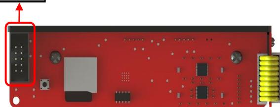
\* 通信协议为modbus RTU，ID可以修改。
